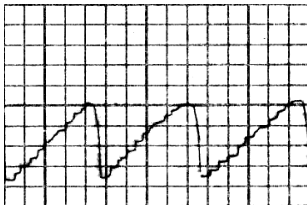
Рис. 7. Фрагмент профилограммы центральной зоны фокусатора в «кольцо», увеличение по вертикали – 1000, увеличение по горизонтали – 20, размер клетки 2х2мм.
