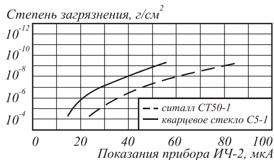
Рис. 7. Градуировочная кривая прибора ИЧ-2.
