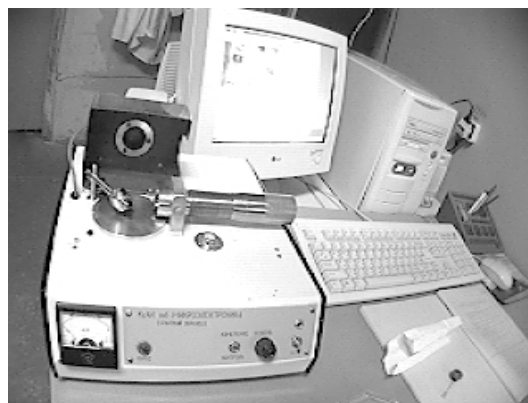
Рис.3. Общий вид прибора экспресс-контроля степени чистоты подложек.
