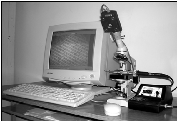
Рис. 4. Установка для штамповки рельефа на торце ИК-волновода
