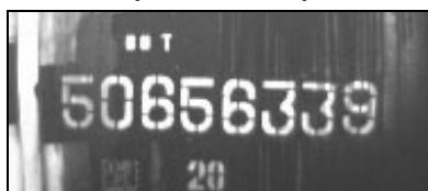
Рис. 9. Пример номера, в котором цифры «6» и «9» похожи на цифру «8»
