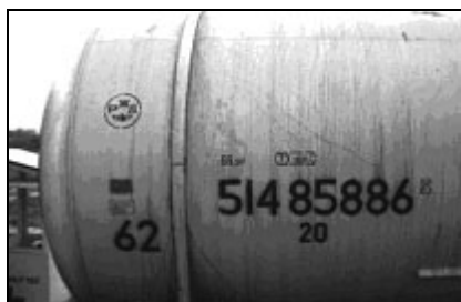
Рис. 1. Информация о цистерне: восьмизначный номер, тип (62) и код принадлежности стране (20)
