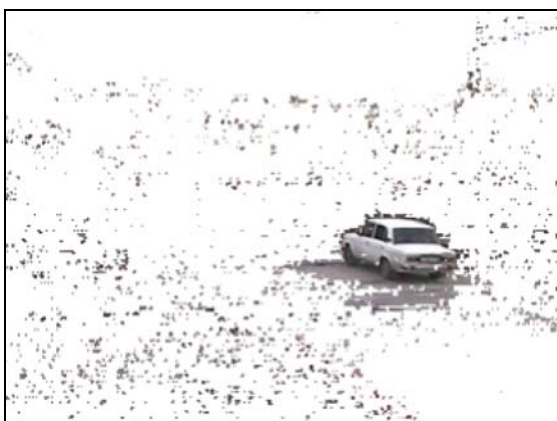
Рис. 6. Разность кадров n+1 и n с обработкой каждого пикселя
