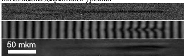
Рис. 5. Локализация в пространстве экситонной плазмы (вверху) и необратимой модификации структуры плавленого кварца в лазерной каустике (внизу и посредине): \tau=120 фс, \lambda=800 нм, расходимость 0,3 мрад, энергия импульса E=2 мкДж. Нижнее изображение получено в режиме теневой фотографии
