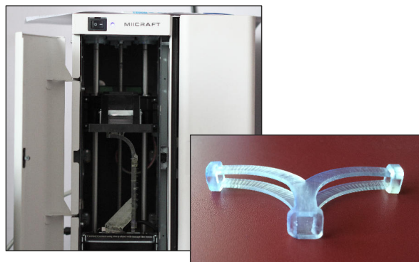
Рис. 7. MiiCraft и корпус оптического делителя
