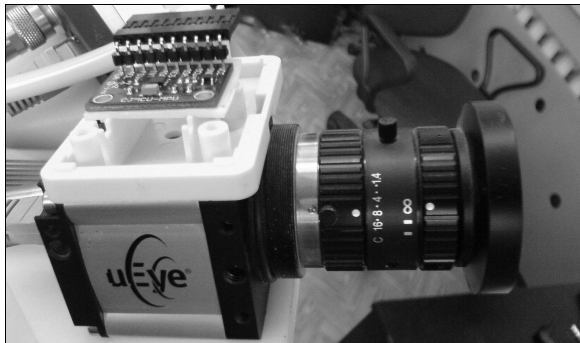
Рис. 4. Камера IDS uEye 5240 RE с инерциальным датчиком
