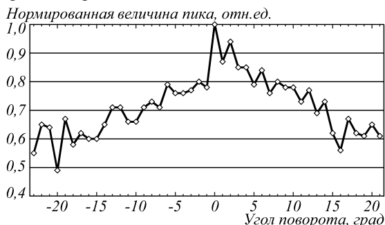
Рис. 5. График зависимости величины корреляционного пика от угла поворота опорного объекта (для объекта с рис. 2а)
