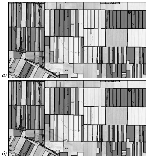
Рис. 6. Границы сегментов (черные линии), полученные на основе неизмененных данных (а) и после создания искусственного пропуска в одном из признаков (б), область пропущенных значений обозначена пунктирной линией, на фоне – изображение признака, в котором была создана область пропущенных значений
