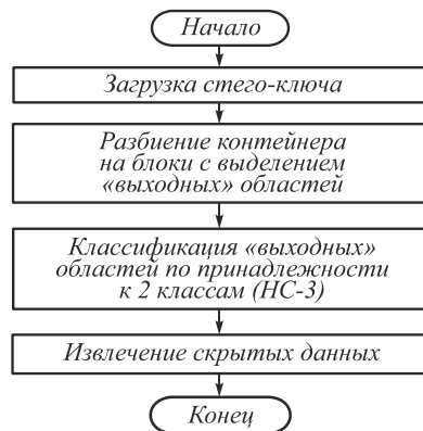
Рис. 4. Обобщённая схема работы алгоритма извлечения данных
