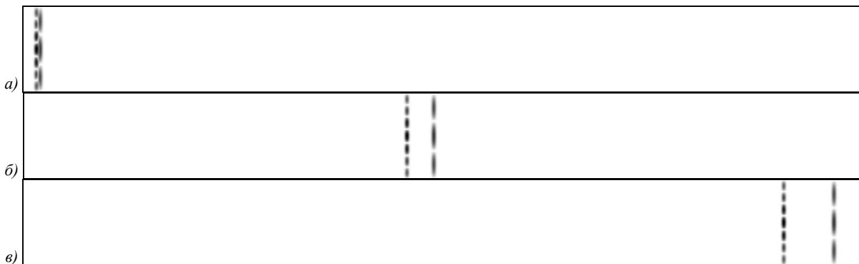
Рис. 4. Распространение суперпозиции двух мод в волноводе длиной 18 мм, распределение амплитуды (негатив) в различные моменты времени: а) t = 5 нс, б) t = 30 нс, в) t = 60 нс
