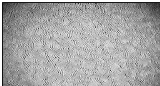
Рис.4. Структура поверхности силиконовой пленки толщиной 2 мкм на стеклянной подложке, получившаяся при воздействии ИК направленного поля. Микрофотография, оптический микроскоп, увеличение X700.
